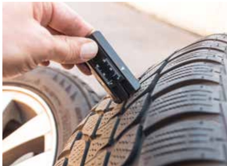
Il est important de toujours vérifier la profondeur du profil de vos pneus. Plus les pneus sont usés, plus la sécurité de conduite en pâtit.
